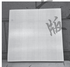
图3 PE-UHMW 纤维复合材料板
