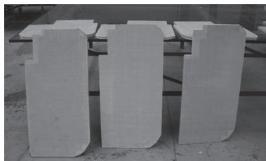
图4 SiC 陶瓷 / 芳纶复合材料产品
